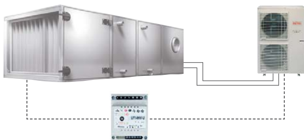
Lüftungsanlage mit INV-Modul
