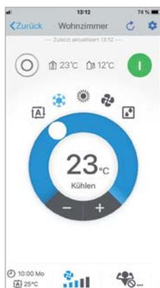
Regelung von Betriebsart, Temperatur, Luftreinigung, Lüfterstufe und Luftstromrichtung
